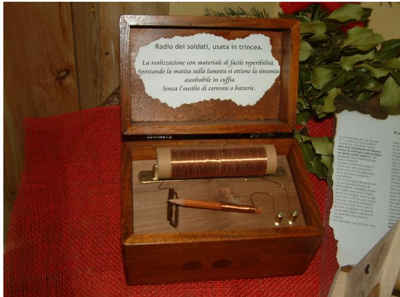
La radio da trincea ricostruita da Benny, dove si vede bene il contatto matita-lametta
