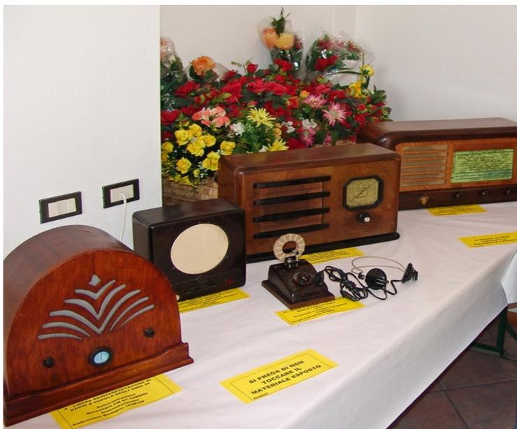
Radio a galena commerciale della ditta Vaam (Milano), anno 1940, anch'essa con la bobina a nido d'ape, in esposizione con altre radio d'epoca.
